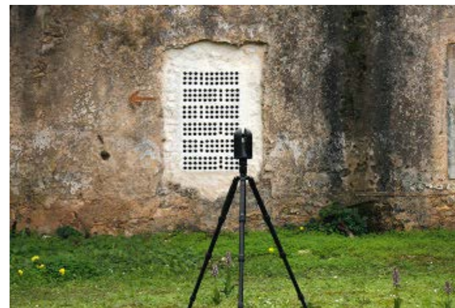
Em cima: fotogrametria da fachada realizada por Ana Tomé e Jesse Rafeiro Em baixo: aparelho que efetua a "nuvem de pontos" 3D
