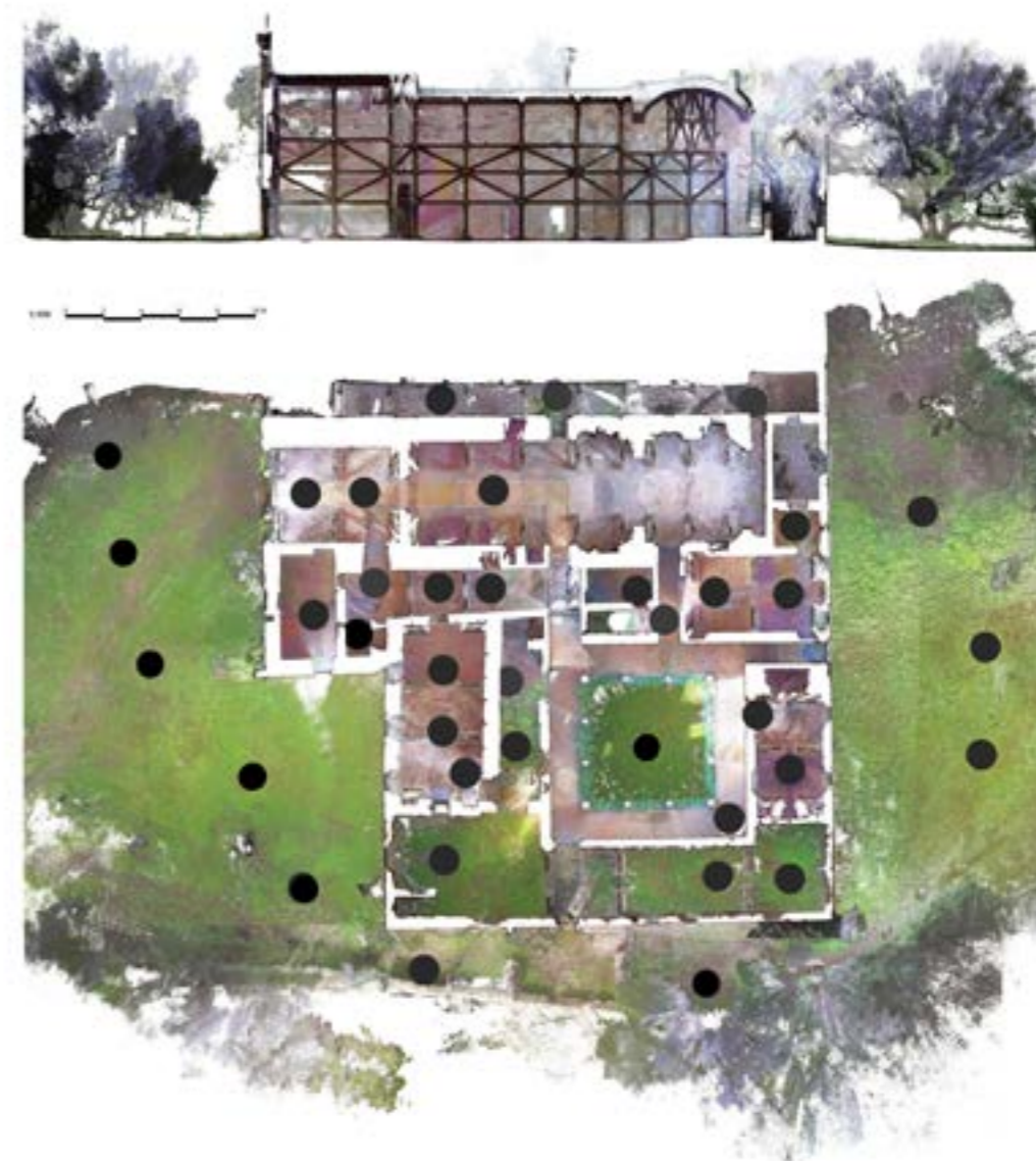
Figura 5 Nuvem de pontos completa a utilizar na modelação digital (os pontos pretos representam algumas das estações de digitalização). Cima: seção longitudinal da igreja. Baixo: piso térreo do convento.
